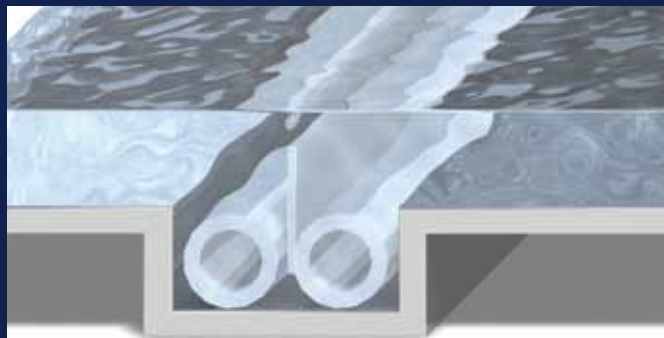
Instalación sumergida: Cajón centrado para dos ejes en el suelo del vaso con tapa eléctrica
